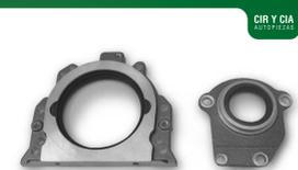
Se fabrican en aluminio inyectado.
